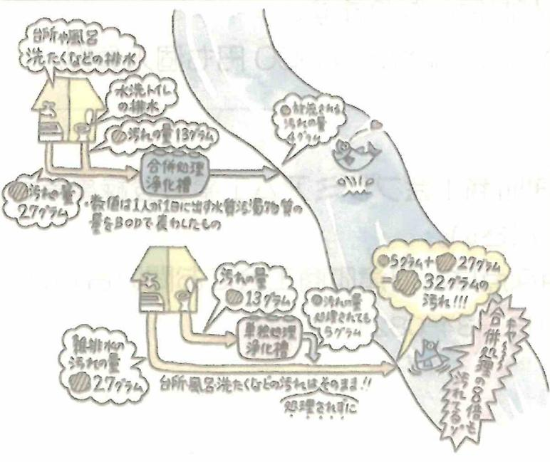
浄化槽には、トイレの汚水（し尿）だけを処理する単独処理浄化槽と、し尿と生活雑排水（台所、風呂、洗濯等の排水）の両方を処理する合併処理浄化槽があります。
