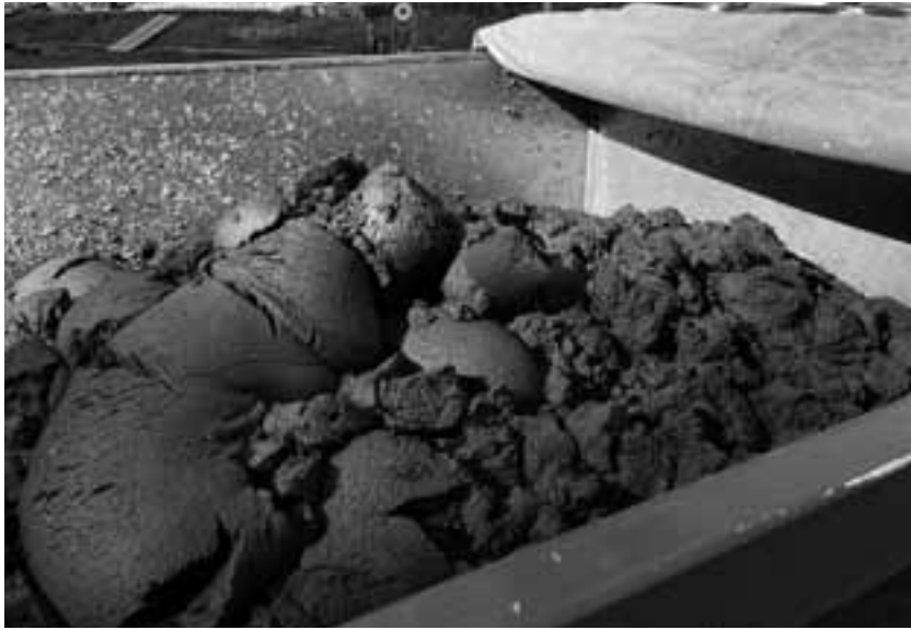
焼却のためトラックで運搬する沈殿汚泥
